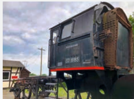
FÜHRERHAUS UND TEILE DES STEHKESSELS EINER GÜTERZUG-DAMPFLOKOMOTIVE DER BAUREIHE 52
